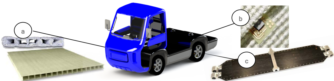
Abb. 3: Integration der SFB-Forschungsergebnisse in den FiF: (a) 3D-Preformen und Spacerstrukturen, (b) werkstoffintegrierte Sensornetzwerke oder (c) funktionsintegrierte Composite-Blattfeder
